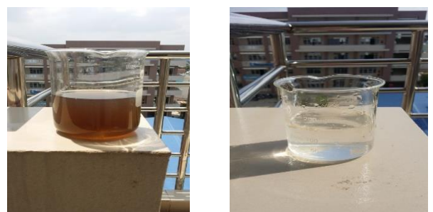
Hình 10. Nước thải trước và sau xử lý của hệ oxalate Fenton
